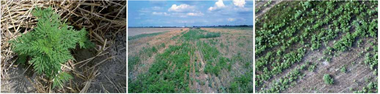
9. ábra. Parlagfűvel fertőzött parcella terepi felvételei és a 2 cm terepi felbontású repülőgépes fényképezésű ortofotó-mozaik részlete. A felvételek az Interspect kutatási programjához készültek, egy időben ábrázolják a vizsgálati parcellát. Az Interspect kutatócsoport tapasztalatai szerint a parlagfű biztonságos távérzékeléses térképezéséhez legalább 2 cm terepi felbontású multispektrális felmérés szükséges, amelynek azonban nagy területeket átfogó elvégzése nem gazdaságos.
