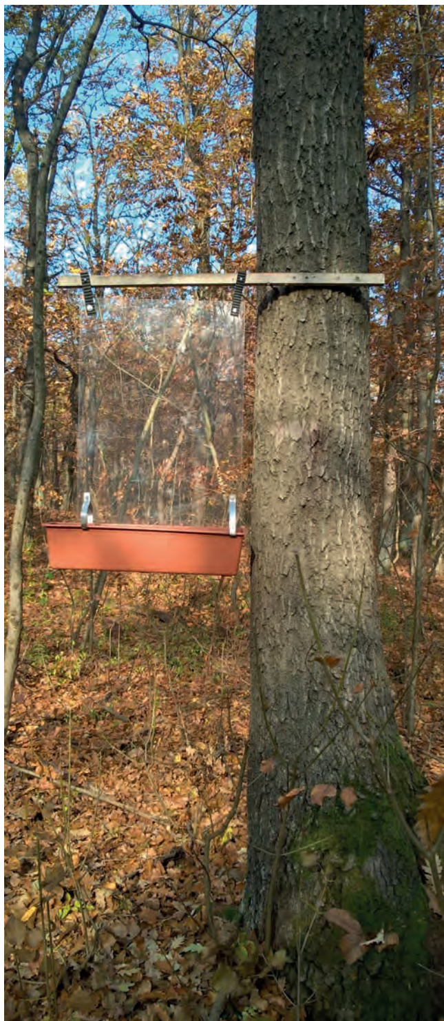
9. ábra. A négy ablakcsapda egyike a plexilap alatt függő fogótartállyal (fotó: Siffer Sándor)
