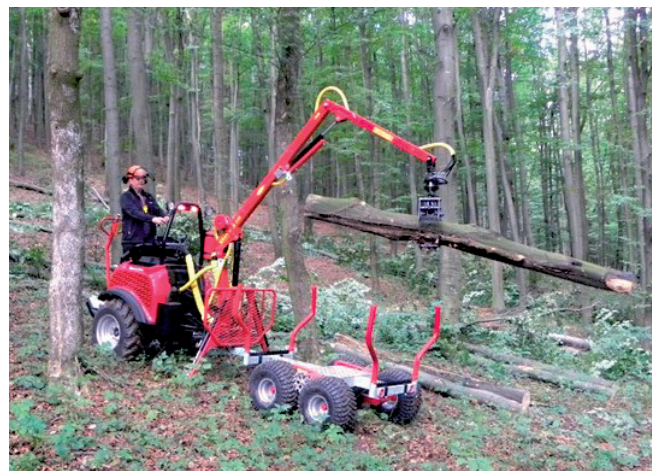
34. fénykép. „Kerekesló” alkalmazása rövid faanyag közelítéséhez (Forrás: www.husquarna.hu).
