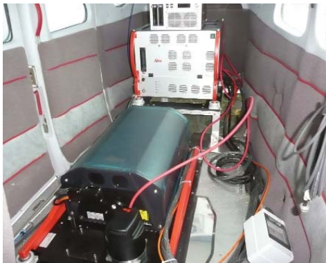
II.4. ábra: Leica ALS70-HP lézertszkenner repülőgépbe beépítve
